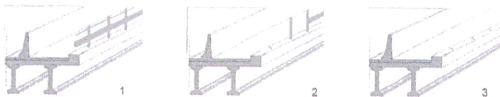
Figura 3 - Fasi di montaggio a cantiere protetto di esecuzione del montaggio
